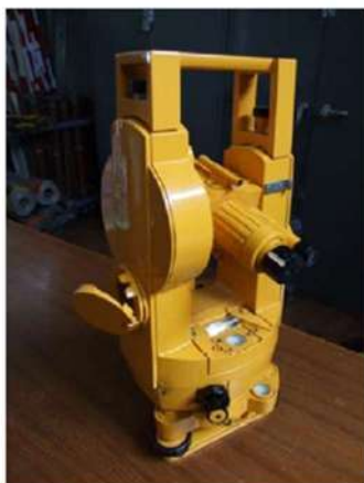
รูปภาพที่ ๑๙ แสดงกล้องวัดมุมแบบอ่านค่าโดยใช้ระบบแสง
