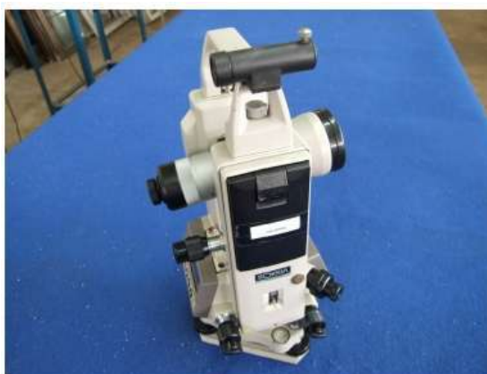
รูปภาพที่ ๒๐ แสดงกล้องวัดมุมระบบอิเล็กทรอนิกส์
